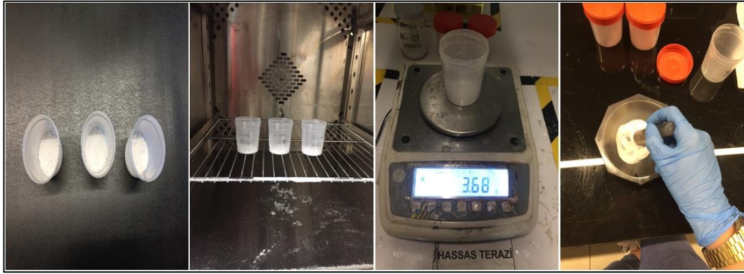
Şekil 4.2. Modifiye edilen \text{Al}_2\text{O}_3 'in hazırlık aşaması
