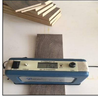
Şekil 4.5. Yüzey parlaklığı ölçümü
