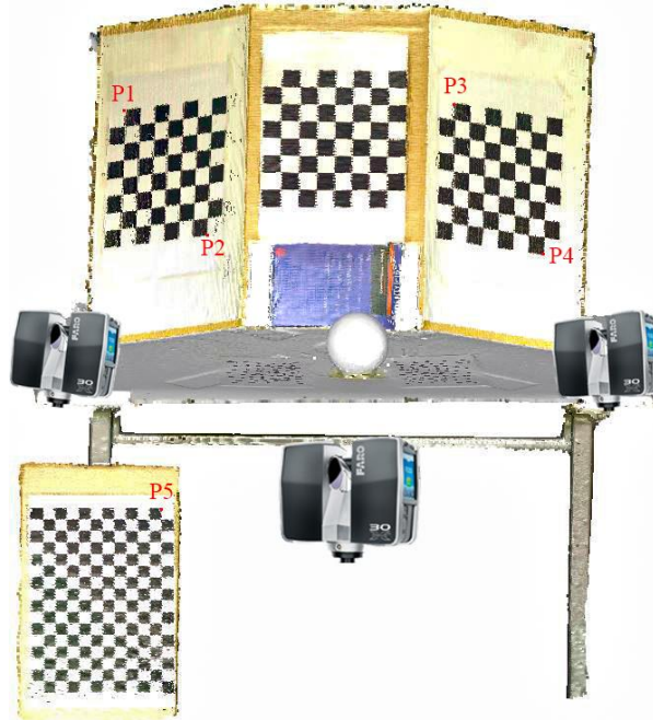
Şekil 24. Referans nokta bulutu, kontrol noktalarının dađılımları ve tarama istasyonlarının gösterimi
