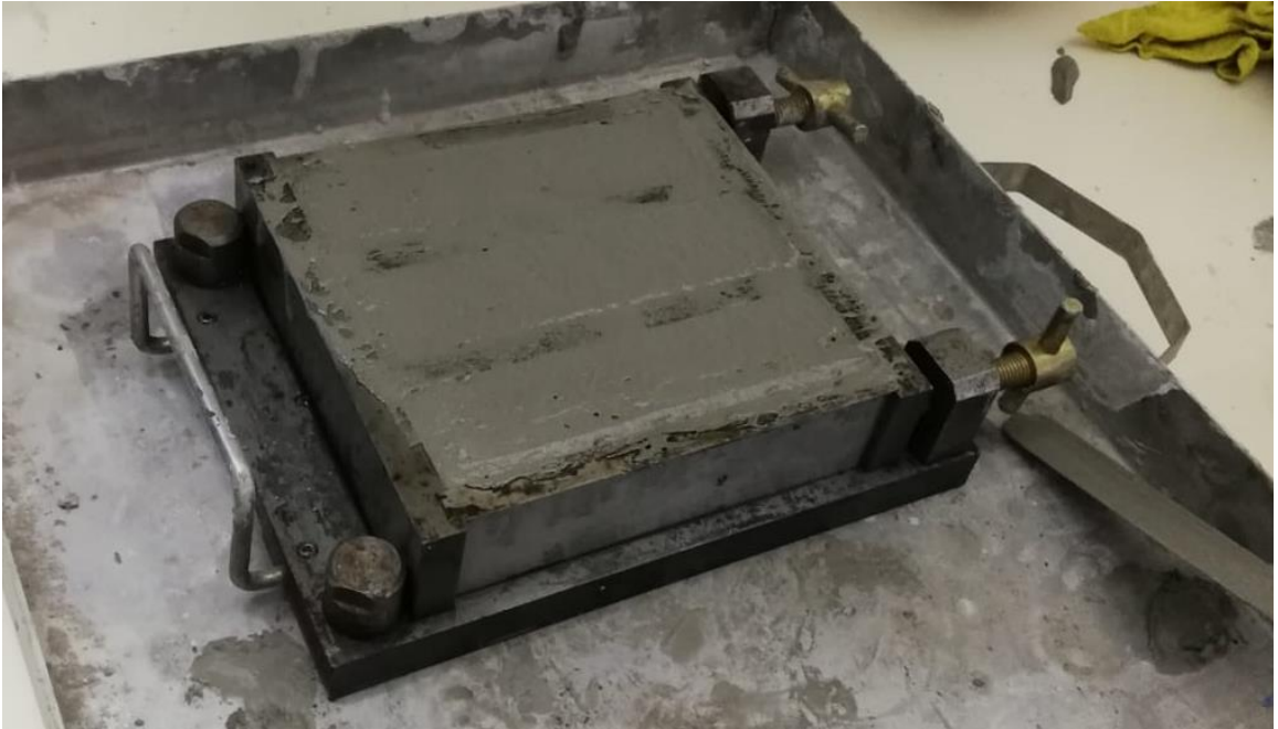
Şekil 4.6. Geopolimer köpük betonların kalıp içerisine döküm işlemi
