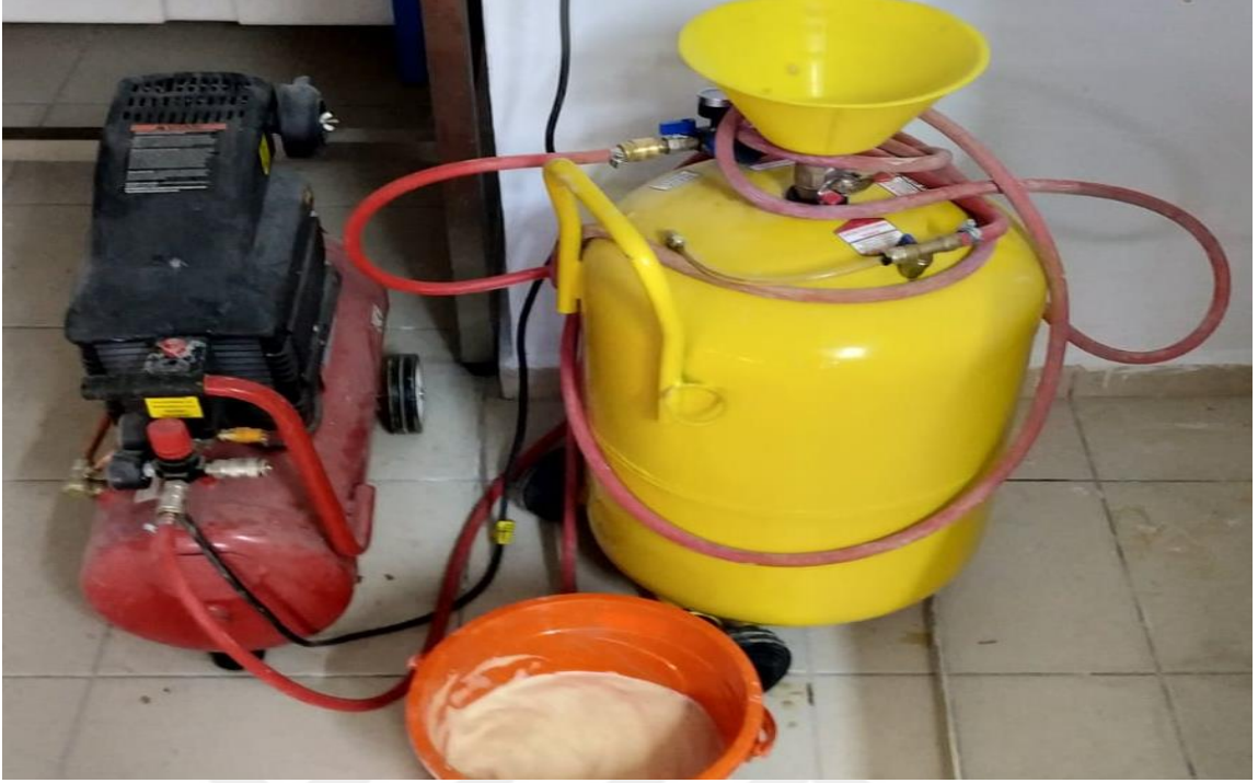
Şekil 4.5. Köpük solüyonu üretimi için kullanılan mekanik düzenek ve köpük solüyonu
