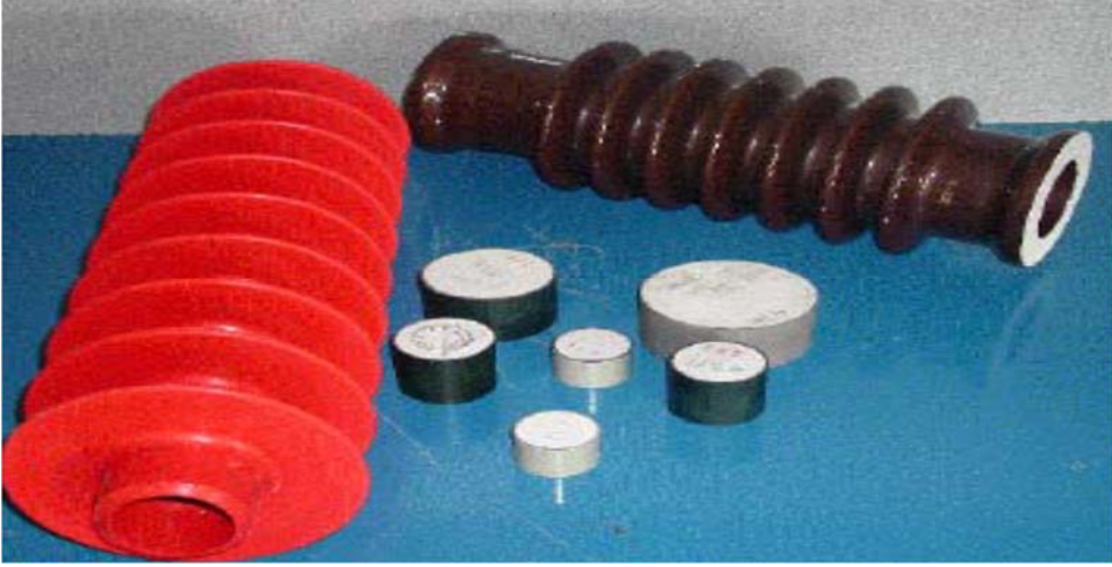
Şekil 3.38. a: Porselen ve polimer parafudr gövdeleri ve dirençleri(Url-11)
