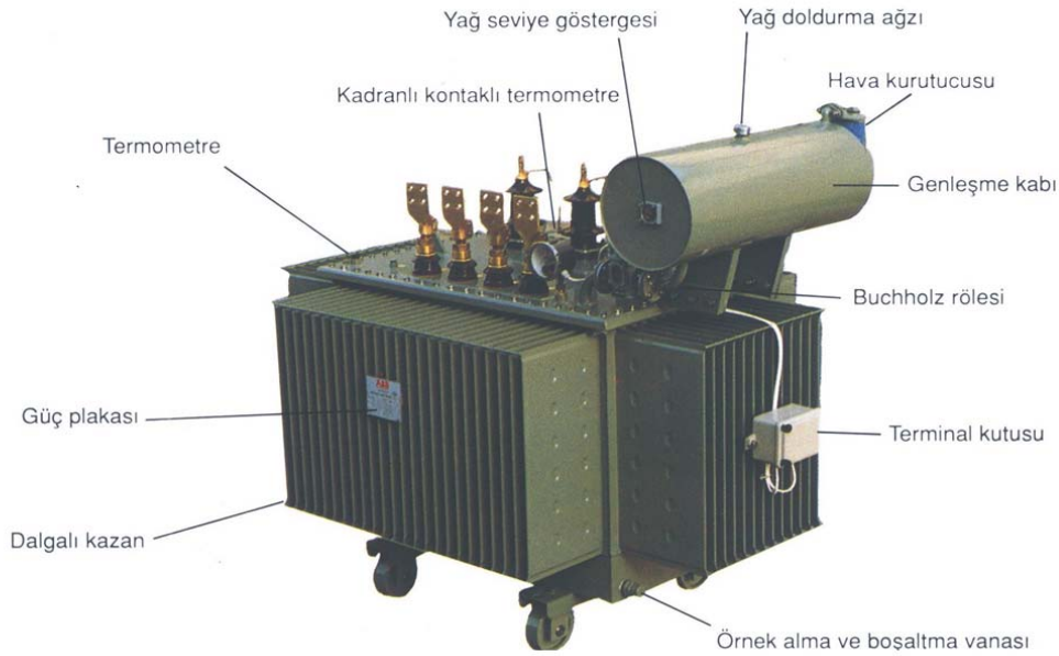
Şekil 3.23. Genleşme depolu transformatör kısımları (Bayer, 2018)
