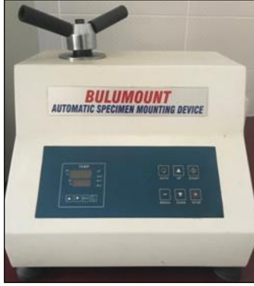
Şekil 5.2. Sıcak bakalite alma cihazı.
