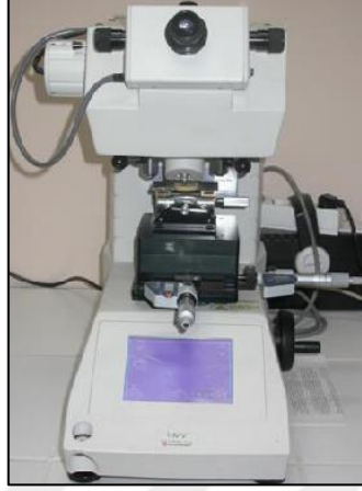
Şekil 5.3. Mikrosertlik ölçüm cihazı.
