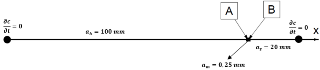
Şekil 4.2. Kübik membranlı sistemin x-yönünde doğrusal gösterimi
