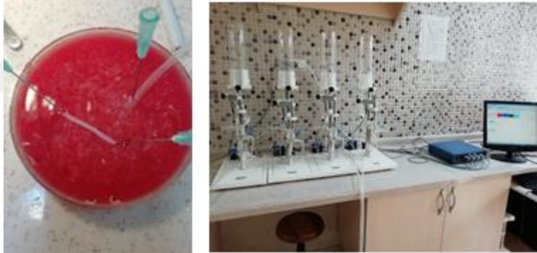
Şekil 3.10. A) İzole edilen aorta preparatı B) İzole organ sistemi ve kas kasılma Parametreleri kayıt sistemi
