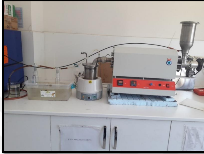
Şekil 4.2.1. Deneyde kullanılan burgu reaktör
