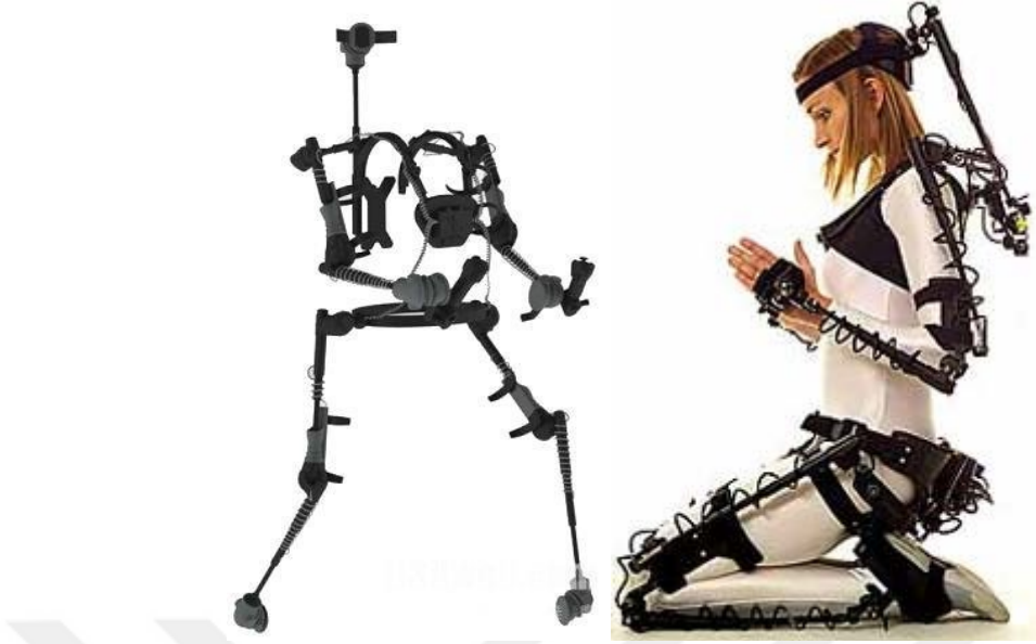
Şekil 2.5. Gypsy 7 Electro-Mekanik Hareket Yakalama Sistemi [40]
