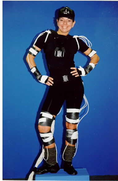
Şekil 2.4. Bobby Bodenheimer-Manyetik Hareket Yakalama Sistemi [38]
