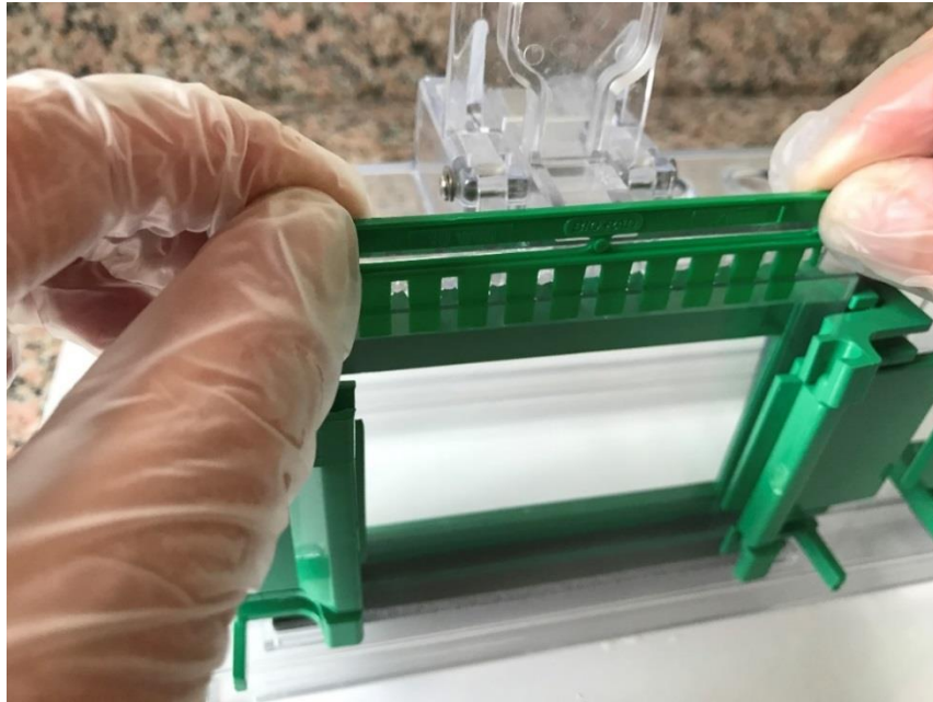
Şekil 3.7. Tamamlayıcı jel solüsyonunun üzerine tarakların eklenmesi
