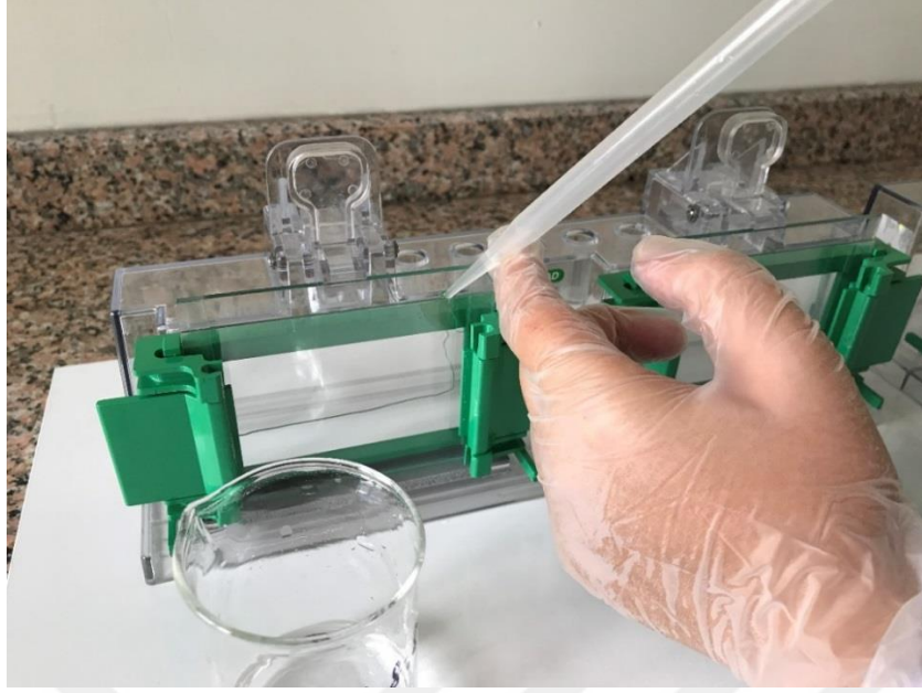
Şekil 3.6. Koşturucu jel solüsyonunun cam plakalara doldurulması
