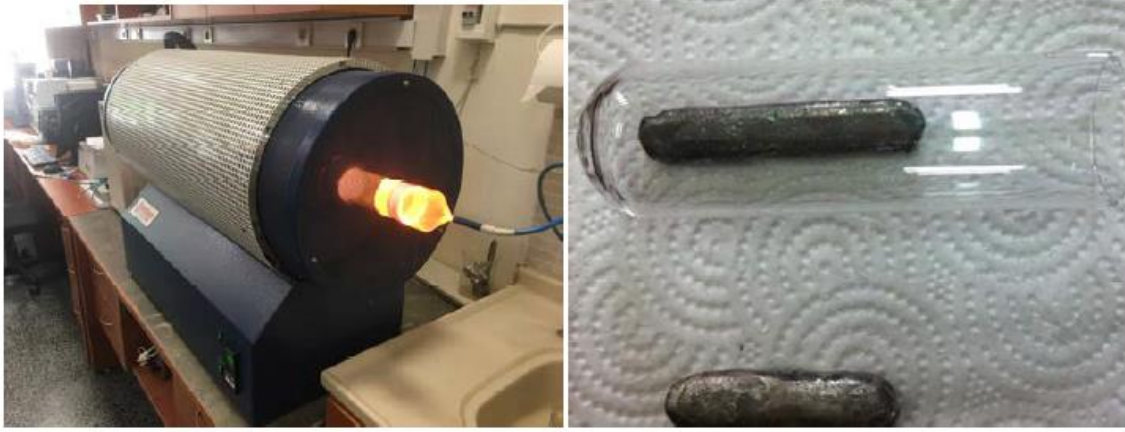
Resim 5.5. Homojenleştirme işlemlerinde kullanılan spektroskopik argon atmosferine (%99,999 saflıkta) alınmış tüp fırın ve quartz tüp içerisine yerleştirilmiş ingot halindeki alaşımlar
