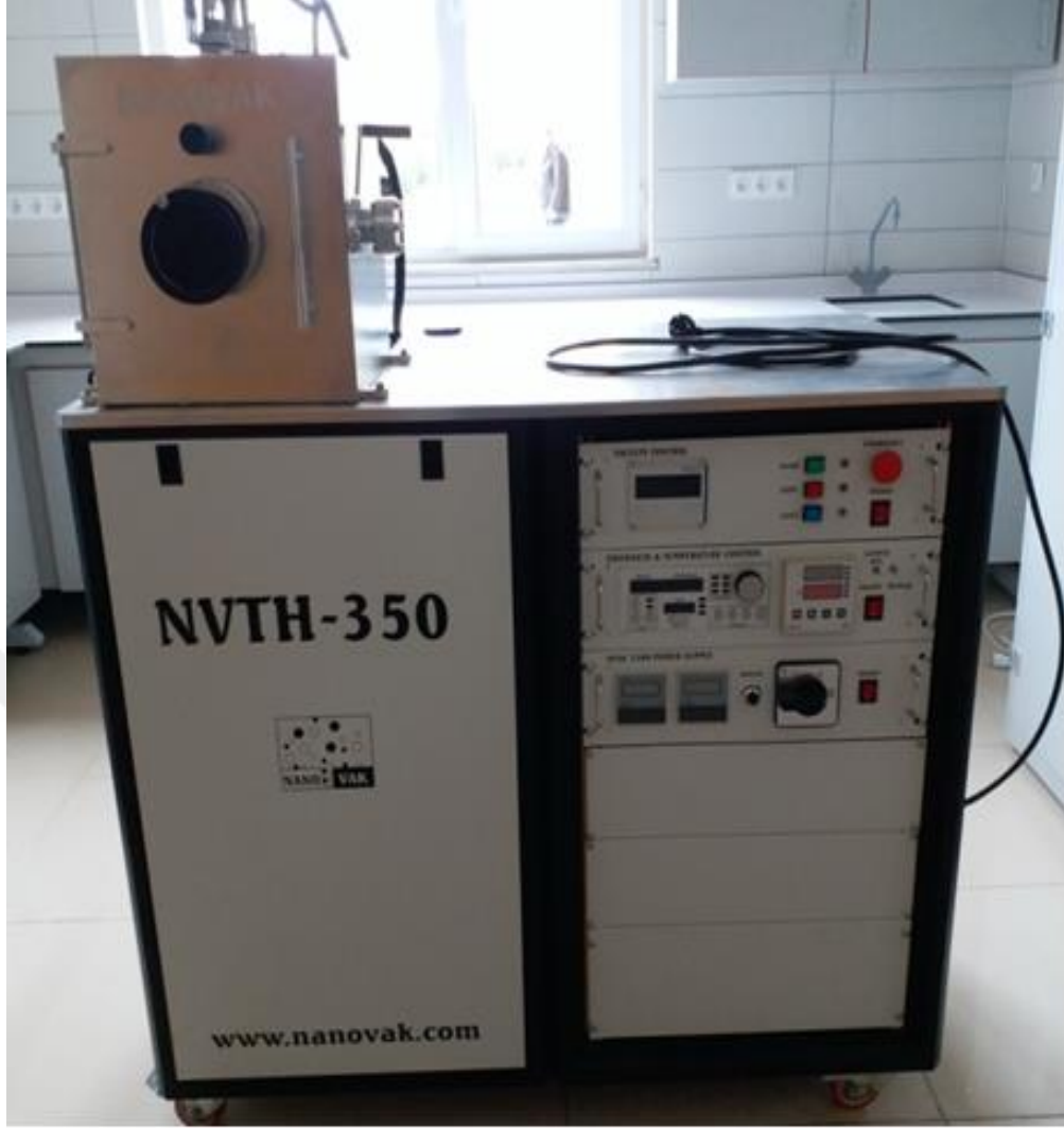
Şekil 3.4. Pb ve Al kaplamasında kullanılan PVD cihazı
