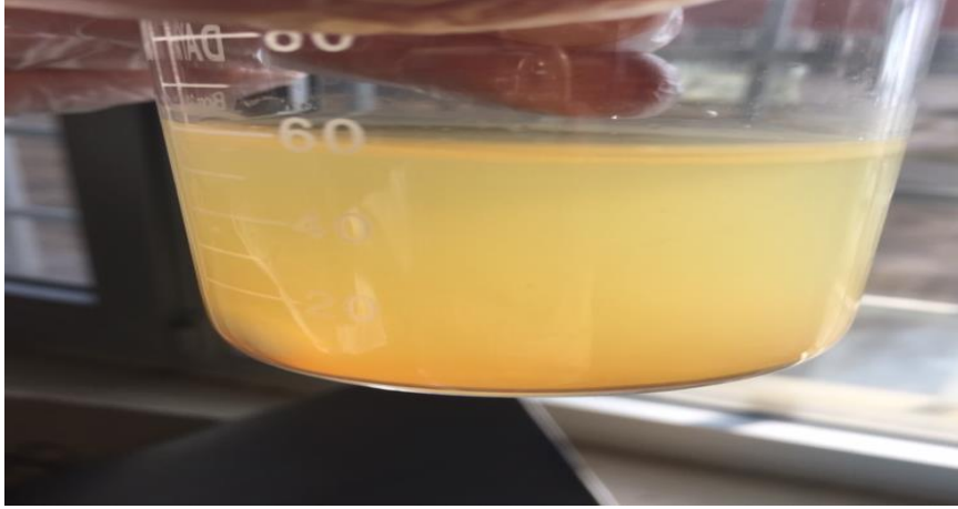
Şekil 3.1. Hazırlanan amonyum hidroksit içeren kurşun asetat trihidrat çözeltisinin fotoğrafı
