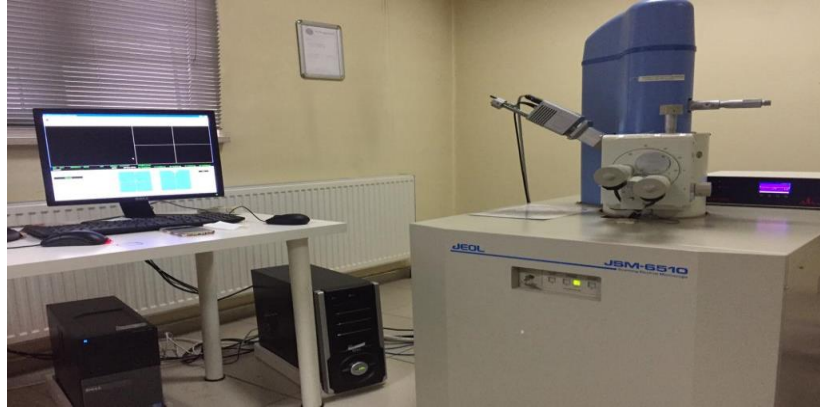
Şekil 4.2. PbO filmin görüntüsünün alındığı Taramalı Elektron Mikroskobu
