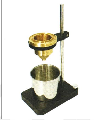
Şekil 3. Viskozimetre (Lehmann) (Arcasoy ve Başkıran, 2020, s.111)
