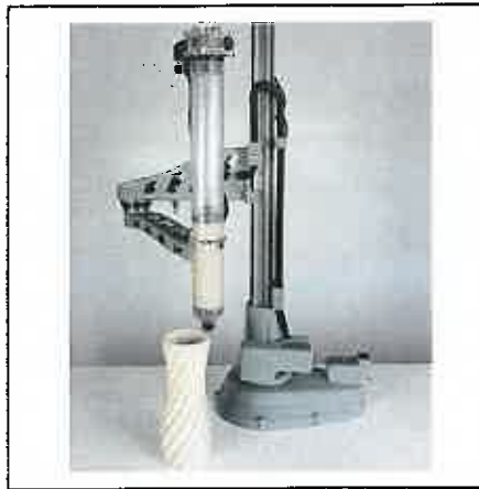
Şekil 1.5.Scara (Robotik kol) Yazıcı Sistemi (3dpotter.com, 2020)
