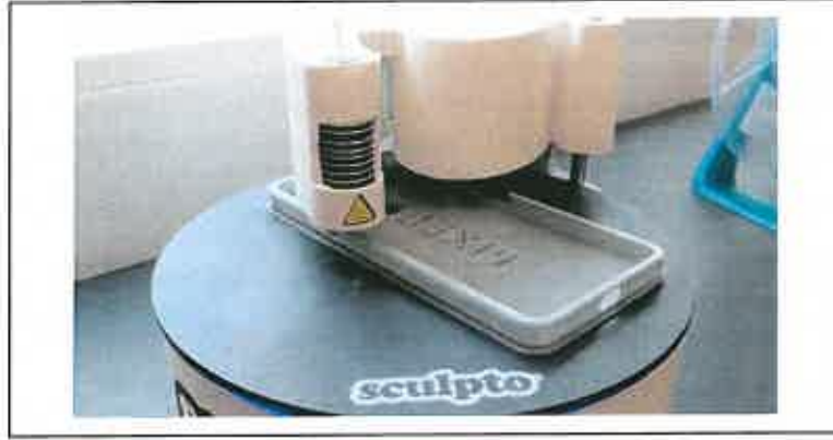
Şekil 1.4. Polar Yazıcı Sistemi (Sculpto Aps,2020)
