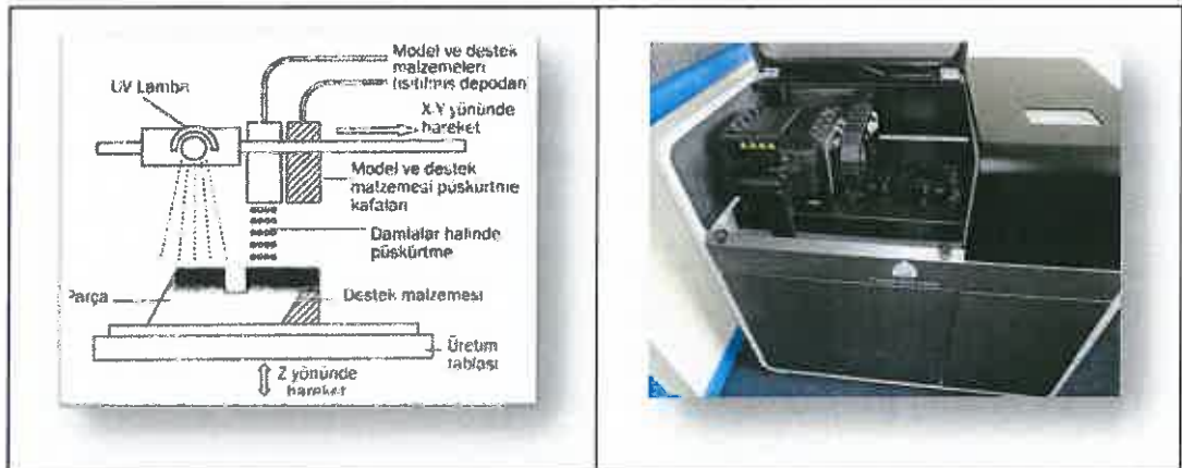
Şekil 1.20. MJM Çalışma Prensibi ve Örnek Cihaz (dergipark.org.tr, 2020)
