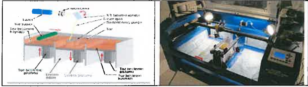
Şekil 1.24. SLS Çalışma Prensibi ve Örnek Cihaz (dergipark.org.tr, 2020)
