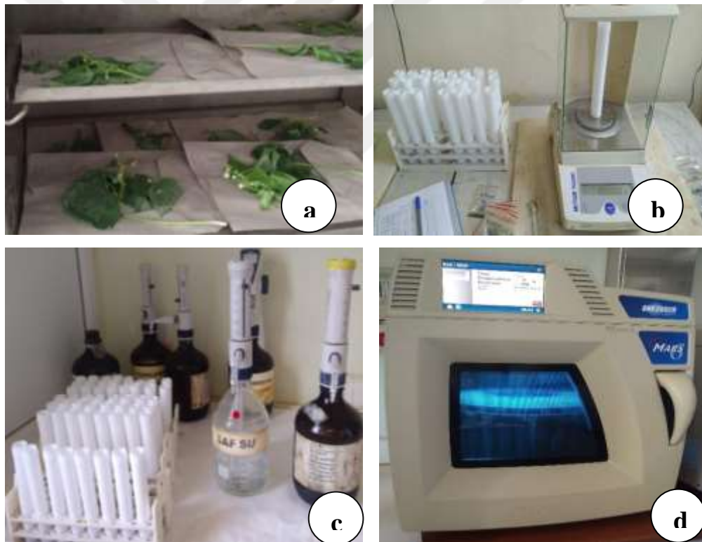
Şekil 3.7. Bitkilerin sabit ağırlığa getirilmesi (a), Öğütülmüş bitkilerin tartımı (b), Örneklere HNO 3 ve saf su eklenmesi (c), Örneğin mikro dalga cihazında çözündürülmesi (d)
