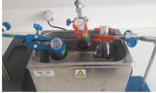
Şekil 3.1. Katalizörlerin ultrasonik banyoda karıştırılması.
