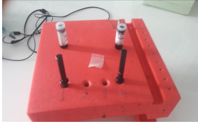
Şekil 3.2. Çalışma elektrotu üzerine modifiye edilen katalizörler.
