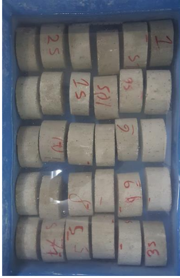
Şekil 3.14. Su Emme Deneyi a) Kür suyu içindeki numuneler b) Etüv içerisinde kurutulan numuneler
