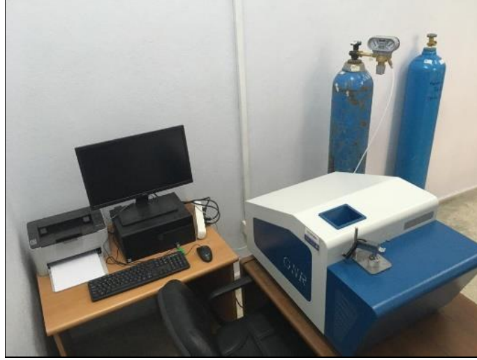
Şekil 5.3. Spektral analiz cihazı.
