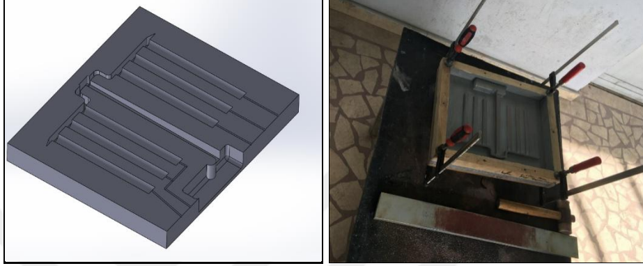
Şekil 5.2. Metal kalıbın CAD görüntüsü (a) ve kum kalıp modelin maça sandığı görüntüsü (b).
