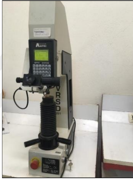
Şekil 5.6. Makro sertlik cihazı.
