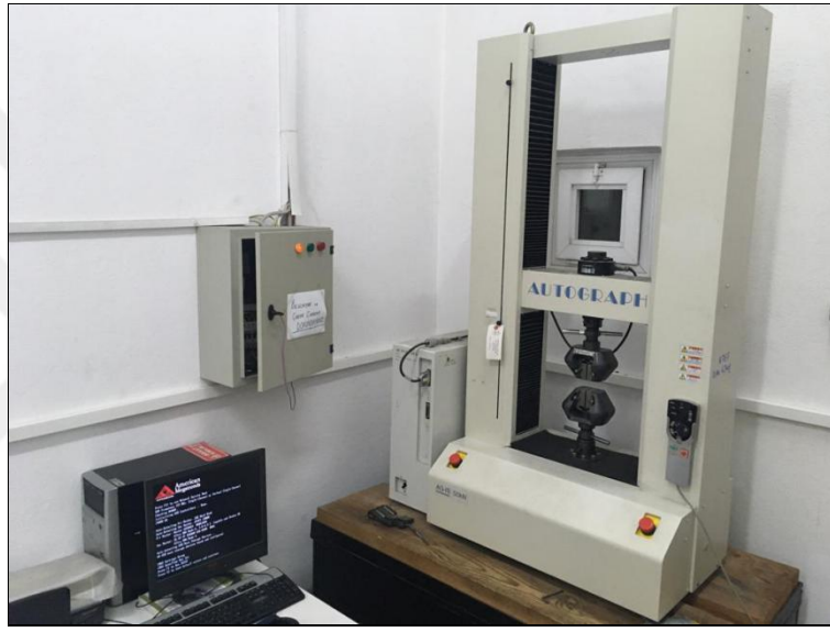
Şekil 5.8. Çekme test cihazı.
