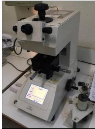
Şekil 5.5. Mikro sertlik cihazı.
