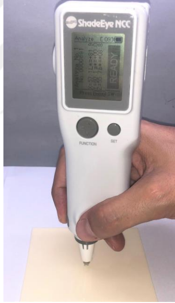
Resim 8: Kolorimetre cihazı ile yapılan renk ölçüm işlemi
