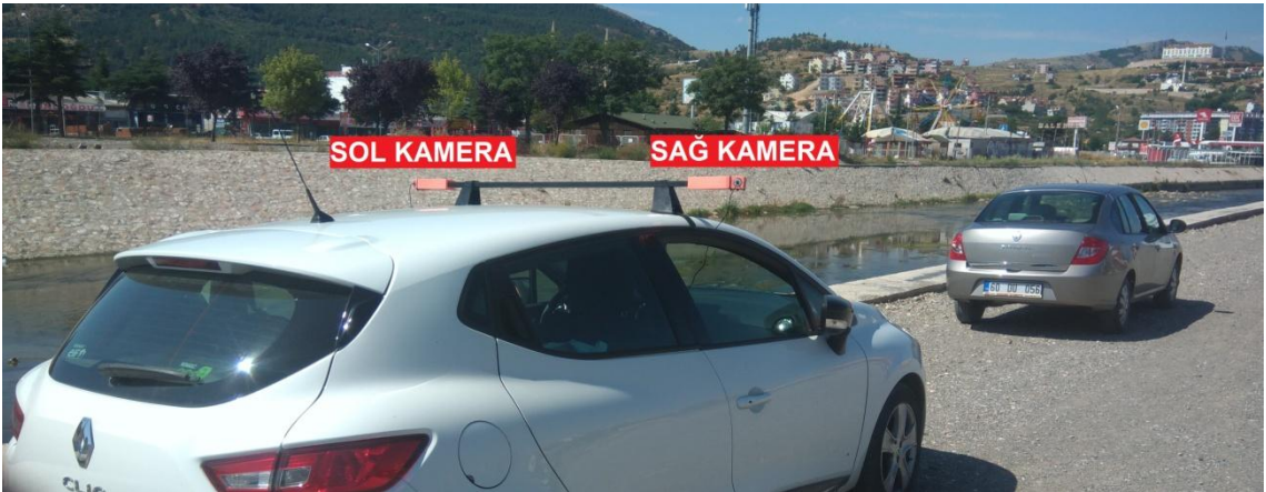
Şekil 3.10. Görüntü alma platformunun araç üzerine yerleştirilmiş hali
