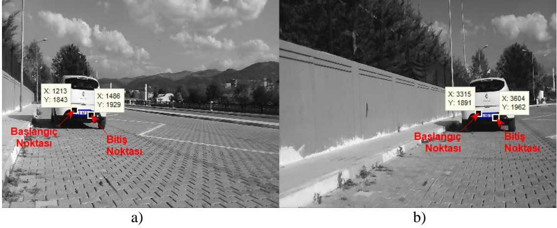
Şekil 3.13. Plaka bölgeleri belirlenmiş stereo kamera görüntüleri (a: Sol kamera görüntüsü ve b: Sağ kamera görüntüsü)
