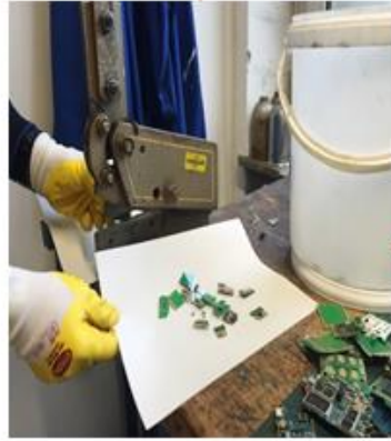
Giyotin makas yardımı ile 2x2 cm'e parçalama
