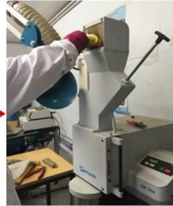
Retsch marka SM300 model tungsten karbid kaplı kırıcı/öğütücü
