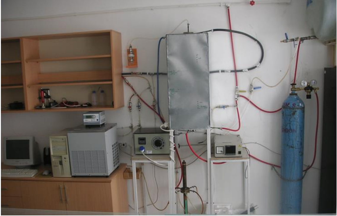
Fotoğraf 3.3. Doğrusal (Kontrollü) katılaştırma fırını ve deney sistemi
