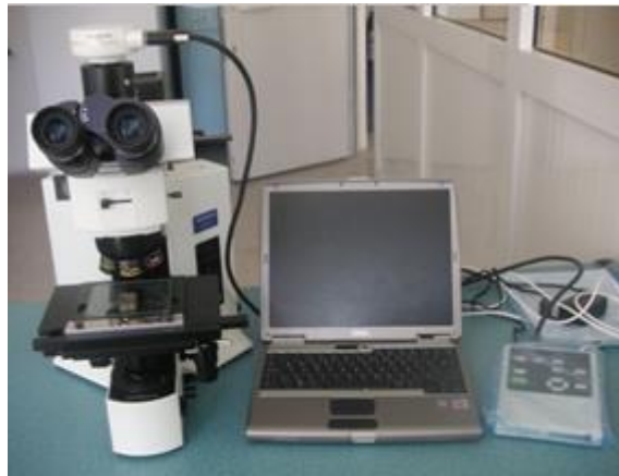
Fotoğraf 3.6. Struers BX-51 model optik mikroskop
