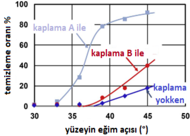
Şekil 2.19. Anti-toz kaplamanın yapışma kuvveti üzerindeki etkisi (Kawamoto and Guo, 2018).
