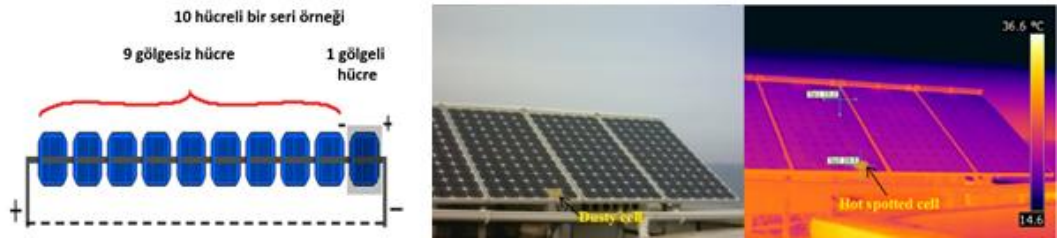
Şekil 2.13. Sıcak leke oluşumu (Maghami et al., 2016; Abderrezek and Fathi, 2017).
