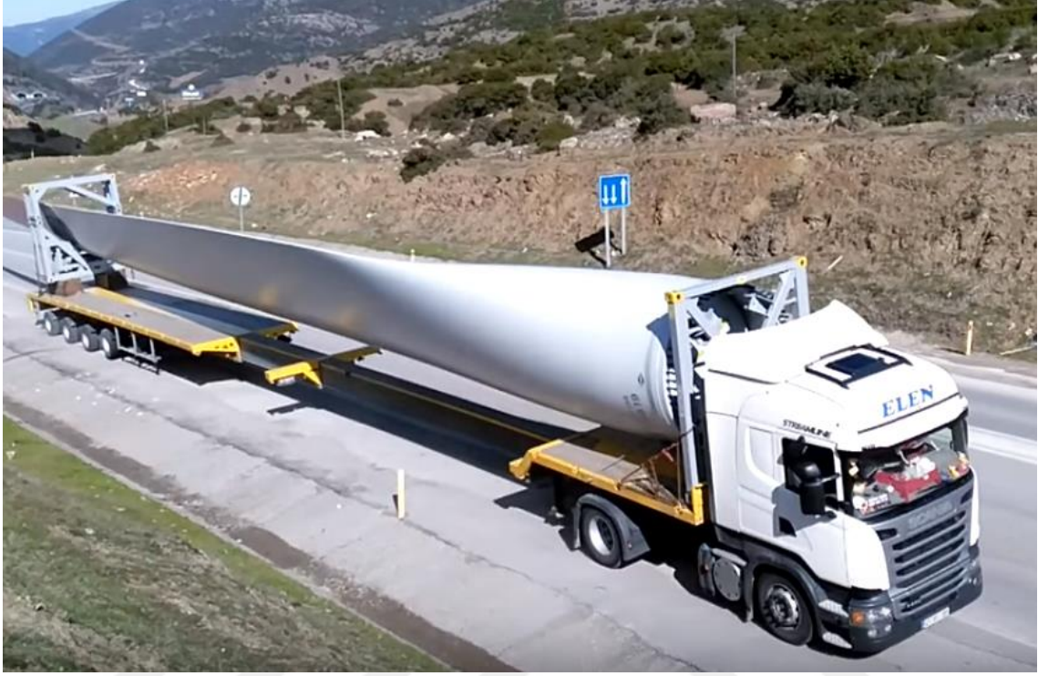
Şekil 1.7. Rüzgar Türbin Kanadının İnşaat sahasına Taşınması
