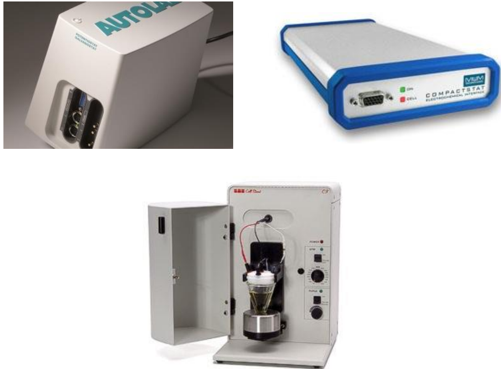
Şekil 3.1. Elektrokimyasal ölçümlerde kullanılan cihazlar ve hücre standı.
