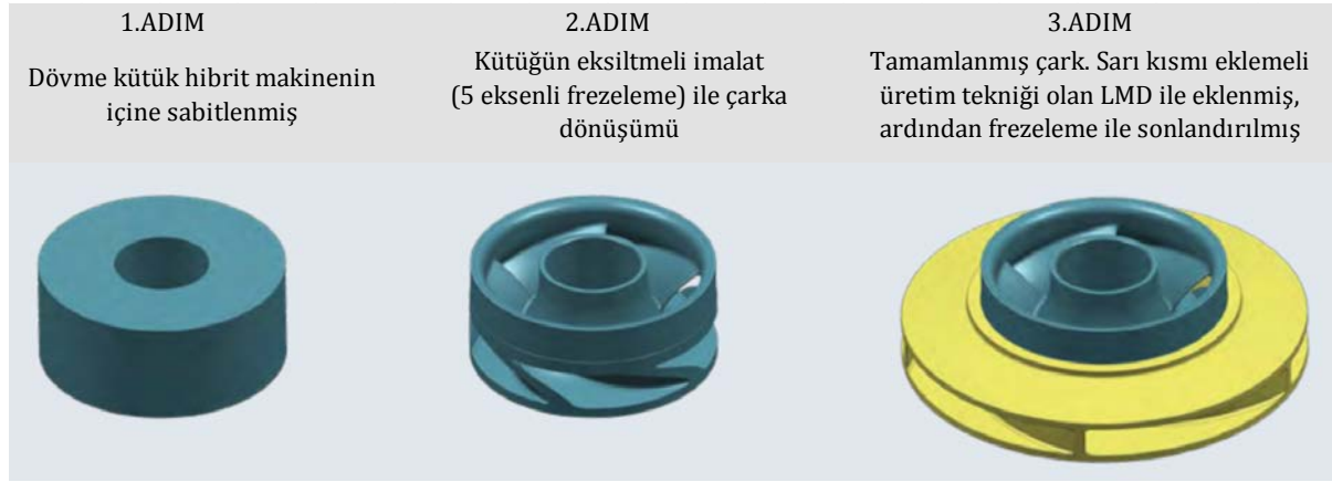
Şekil 2. 23. Hibrit Üretim İle Bir Pervanenin Ana Üretim Aşamaları (Sulzer, 2018: 9)
