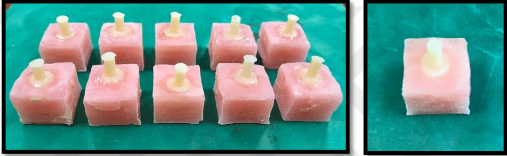
Şekil 3.8. Adezivler uygulandıktan sonra tamir kompozitlerinin uygulanması
