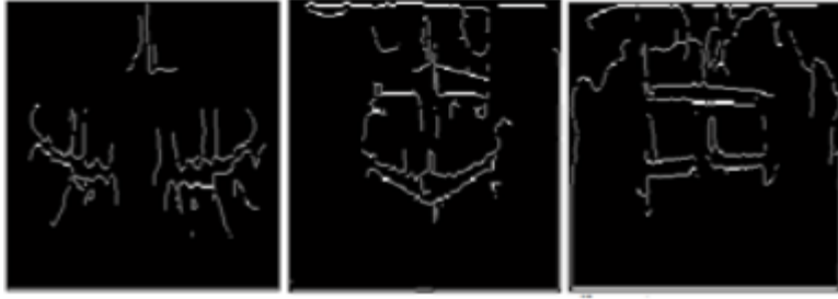
Şekil 6.4. Canny Algoritması ile Elde Edilen Bölütleme Görüntüsü (Trivedi et al., 2015)
