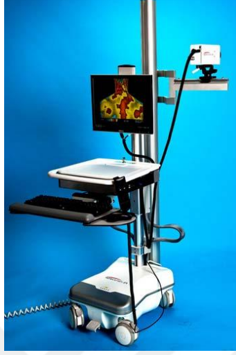
Şekil 4.19. Ticari Kızılötesi Termografi Görüntüleme Sistemi (Kasban et al., 2015)
