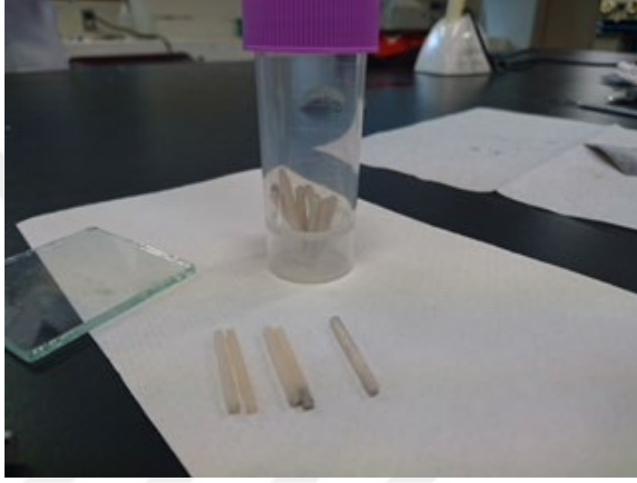
Şekil 2.6. 3 Nokta eğme testi için hazırlanan örnekler
