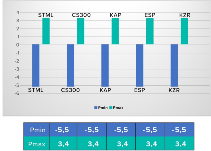
Şekil 3.24. Oblik kuvvet uygulanan modellerdeki spongios kemikteki minimum ve maksimum asal gerilme değerleri (MPa)
