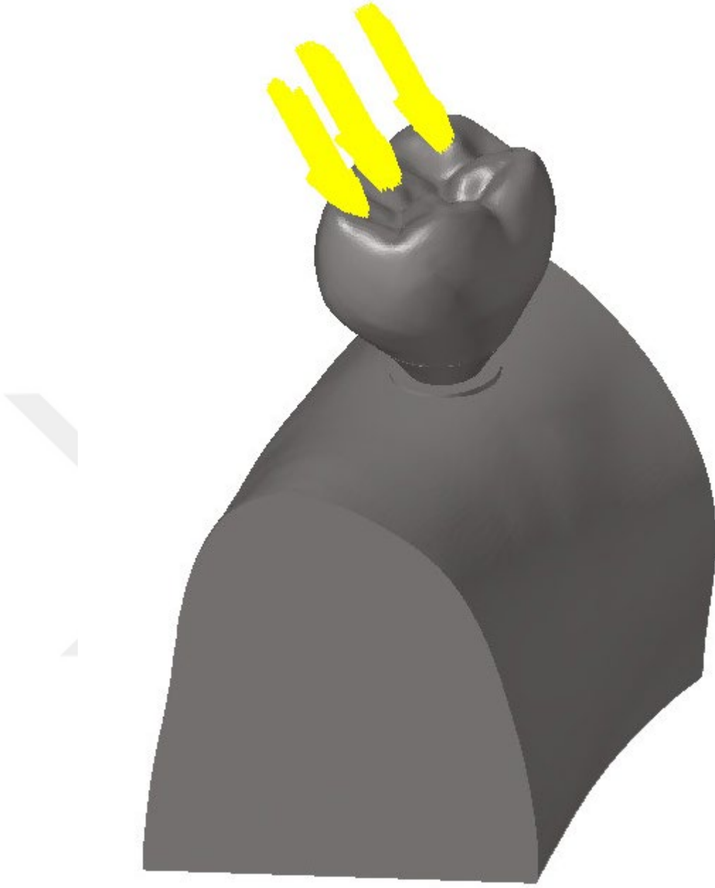
Şekil 2.26. 45° açı ile oblik yükleme senaryosu
