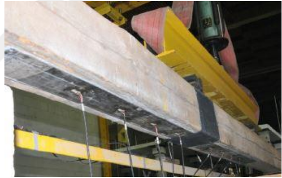
Şekil 189. CFRP İle Güçlendirme [302]
