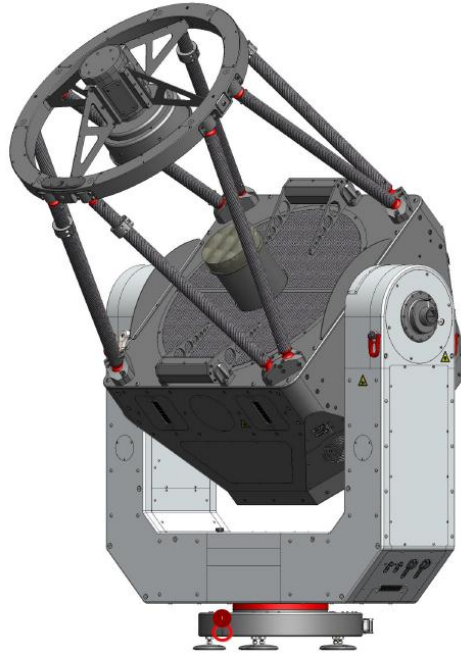
Şekil 3.34 Motor parametre ayarlarına başlamadan önce ayarlanması gereken pozisyon
