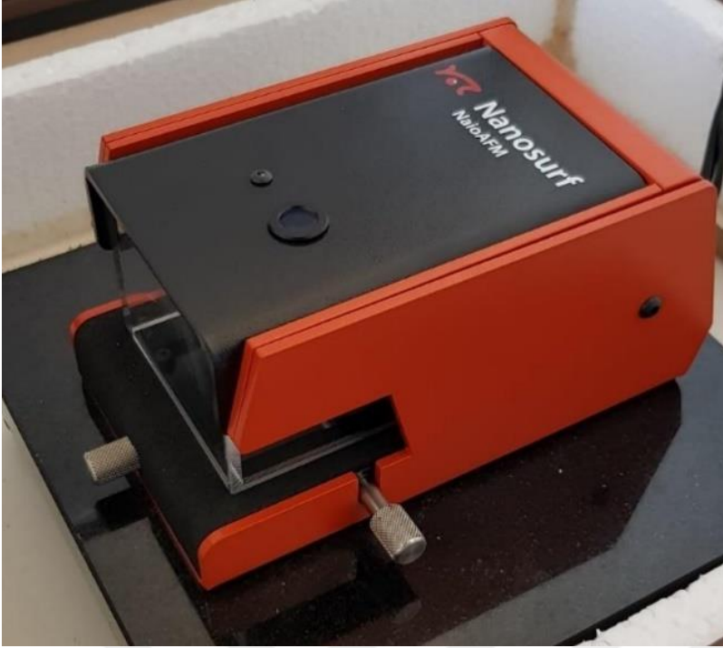
Şekil 21. Nanosurf Naio marka atomik kuvvet mikroskobu (AFM)
