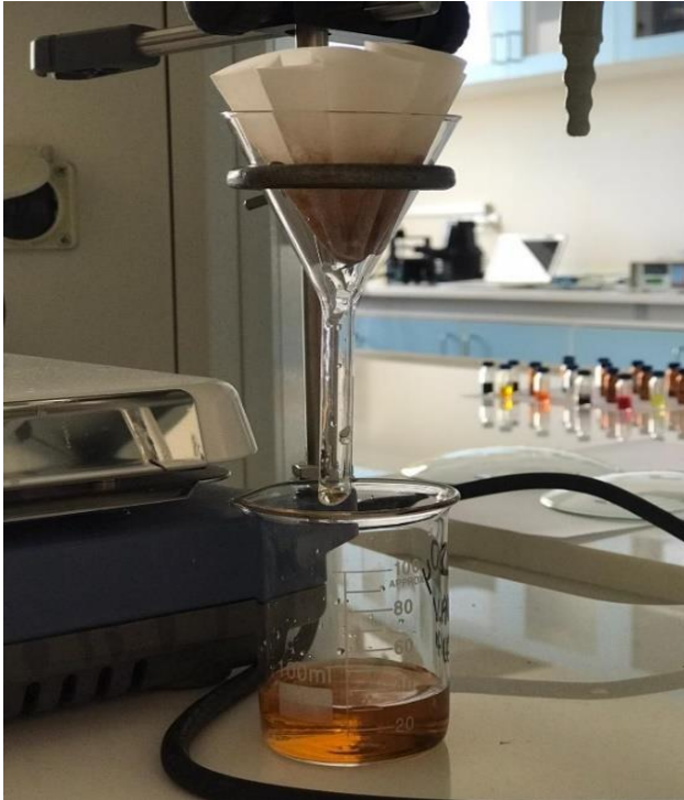
Şekil 28. ALV-ClO 4 tuzunun eldesinde tuzun süzülme işlemi
