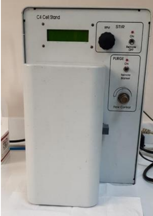
Şekil 23. Elektrokimyasal ölçüm hücresi (CH Instrument 617E)
