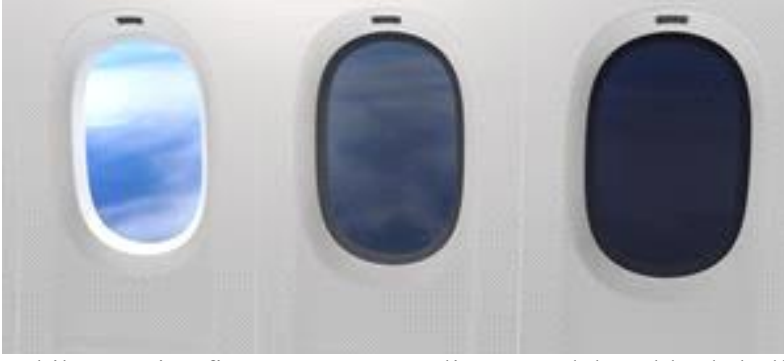
Şekil 5. Boeing firmasının “Dreamliner” model uçaklarda kullandığı elektrokromik camların bir örneği (Globe Newswire)
