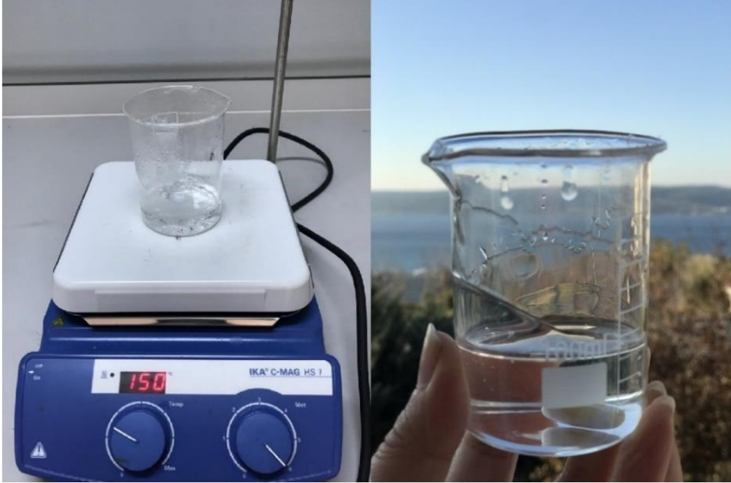
Şekil 29. Manyetik karıştırıcıda 150^\circ\text{C} 'de hazırlanan jel elektrolit
