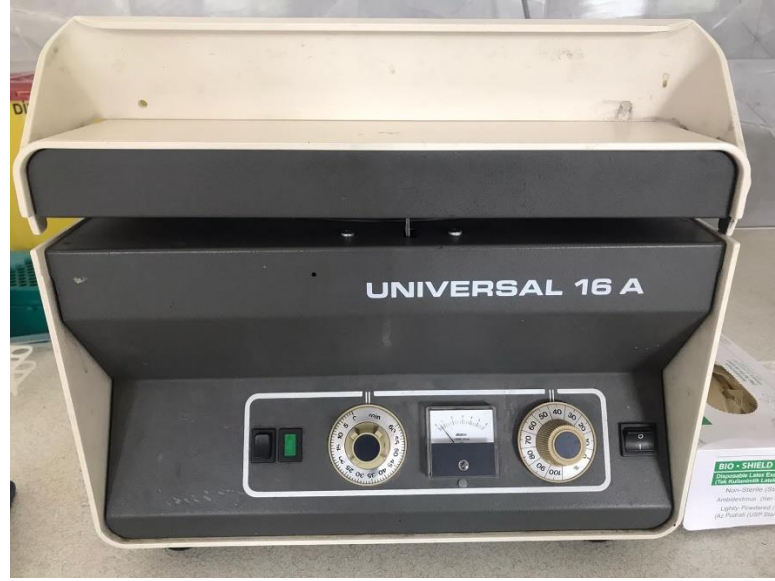
Resim 12. Fakülte laboratuvarında bulunan santrifüj cihazı.
