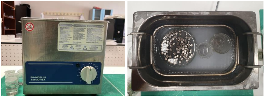
Şekil 3.8. Temizleme İşleminde Kullanılan Ultrasonik Banyo
