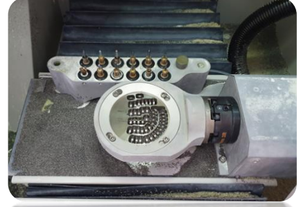
Şekil 3. 5. Milleme Yöntemiyle Üretilen Ti Örnekler
