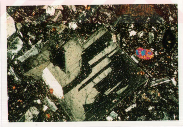
Şekil 12: Yükarıçakmak volkanitine ait bazalt örneğinin mikroskop altında görüntüsü (Büyütme: 1mm = 2.8cm)
