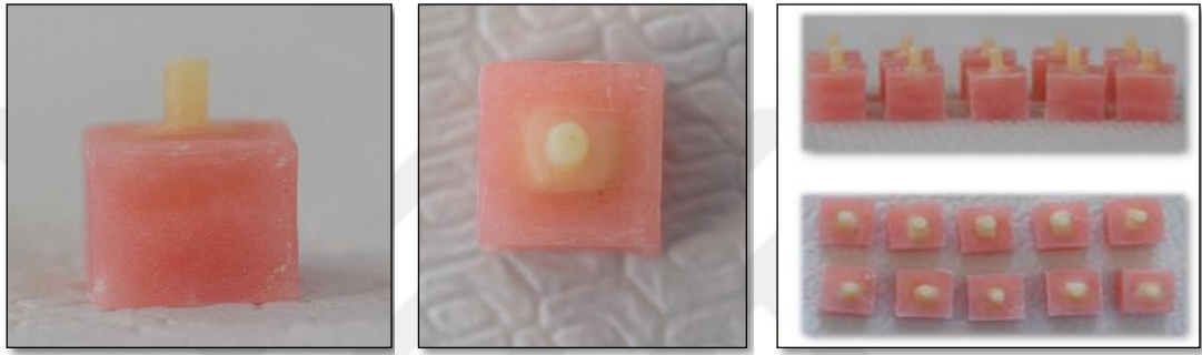
Şekil 3.8: Kompozit rezin bağlanmış diş örneği
