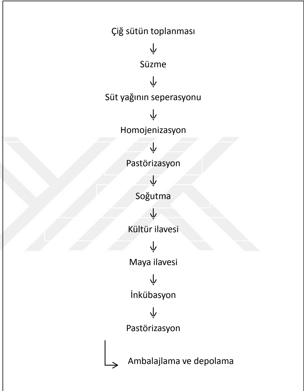
Şekil 2.4. Labne peyniri üretiminde temel proses basamakları [88,90]
