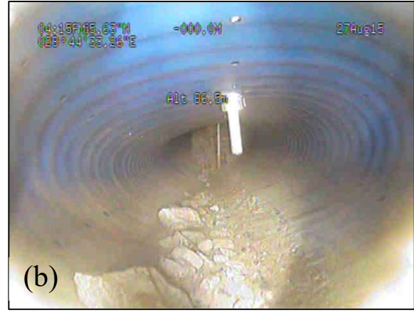
Şekil 4.5 Boru içerisinde alınan görüntüler (a) deney başlamadan önce alınan görüntü (b) Boru 515 kN yük altında olduğu anda alınan görüntü
