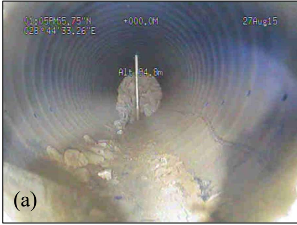
Şekil 4.5 Boru içerisinde alınan görüntüler (a) deney başlamadan önce alınan görüntü (b) Boru 515 kN yük altında olduğu anda alınan görüntü
