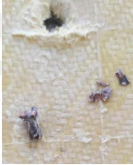
Şekil 7-23 Atışlar Sonucu Numune 2'nin Parçaladığı Merminin Kalıntıları
