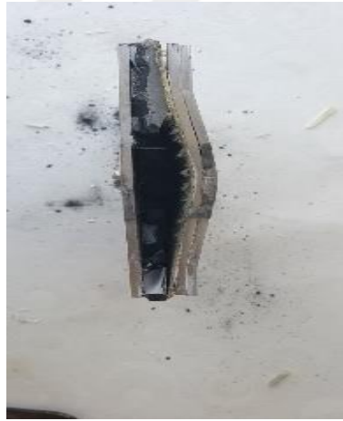
Şekil 7-27 Atışlar Sonucu Numune 3'in Kesit Görüntüsü
