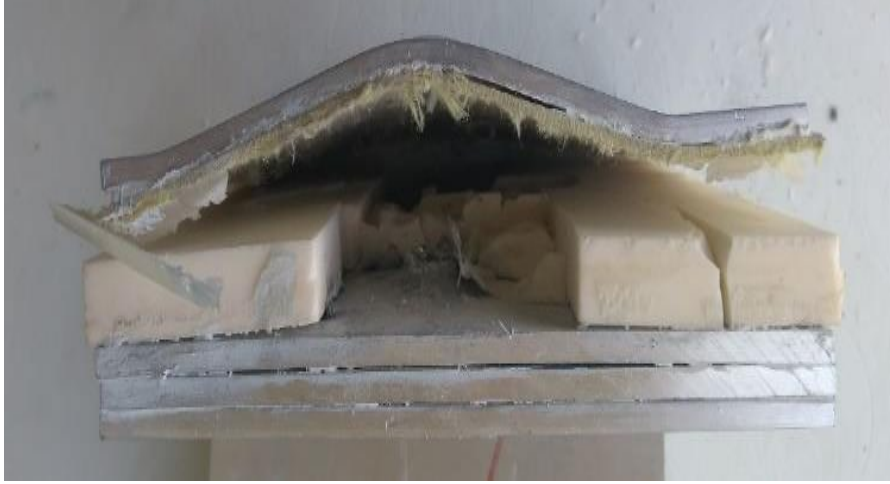
Şekil 7-17 Atışlar Sonucu Numune 1'in Kesit Görüntüsü
