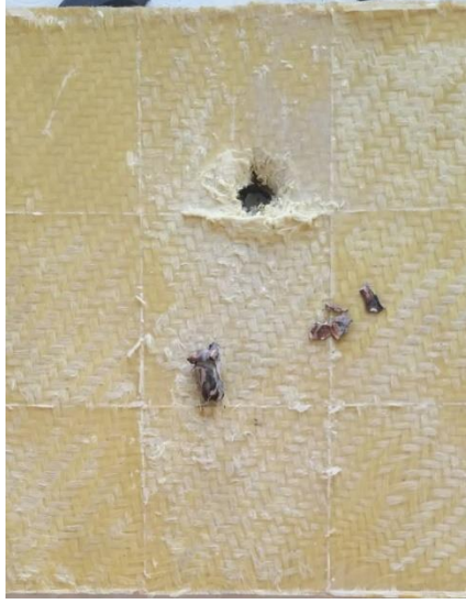
Şekil 7-22 Atışlar Sonucu Numune 2'in Kevlar Yüzeyi
