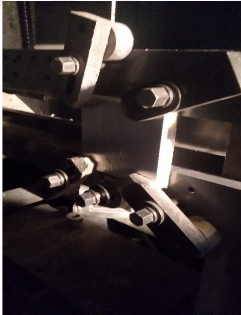
Şekil 7-10 Zırh Paketinin Atış Öncesi Bağlandığı Mekanizma
