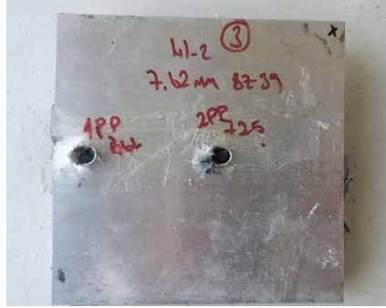
Şekil 7-26 Atışlar Sonucu Numune 3'in Ön Yüzeyi
