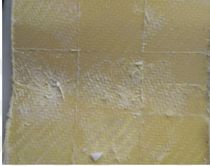
Şekil 7-19 Atışlar Sonucu Numune 1'in Kevlar Yüzeyi
