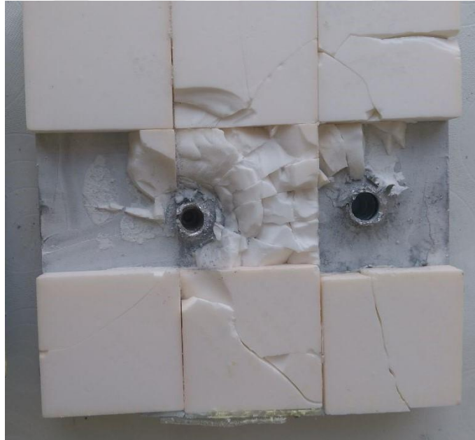
Şekil 7-18 Atışlar Sonucu Numune 1'in Seramik Yüzeyi
