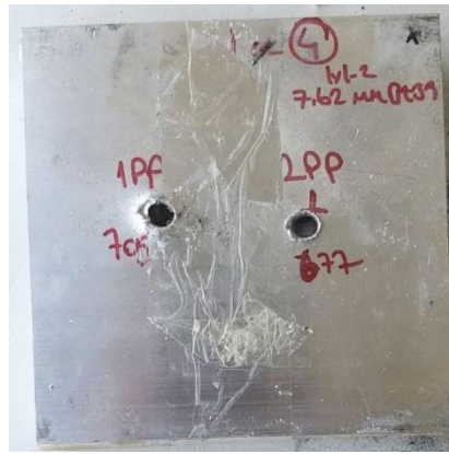
Şekil 7-31 Atışlar Sonucu Numune 4'in Ön Yüzeyi
