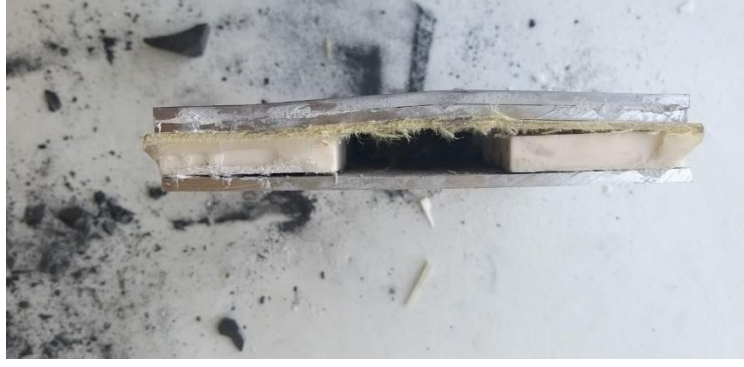
Şekil 7-32 Atışlar Sonucu Numune 3'in Kesit Görüntüsü
