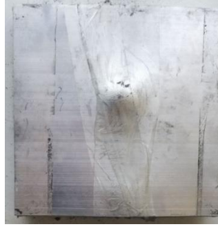
Şekil 7-28 Atışlar Sonucu Numune 3'in Arka Yüzeyi
