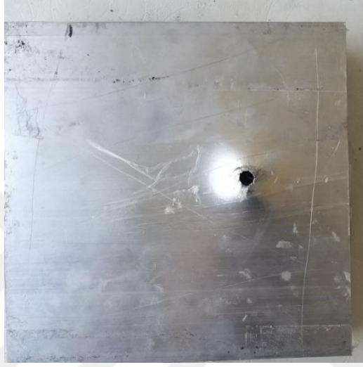
Şekil 7-21 Atışlar Sonucu Numune 2’in Arka Yüzeyi
