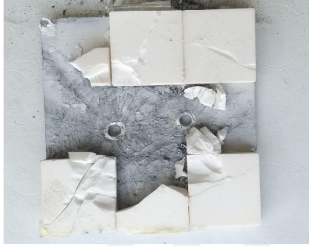
Şekil 7-34 Atışlar Sonucu Numune 3'in Seramik Yüzeyi
