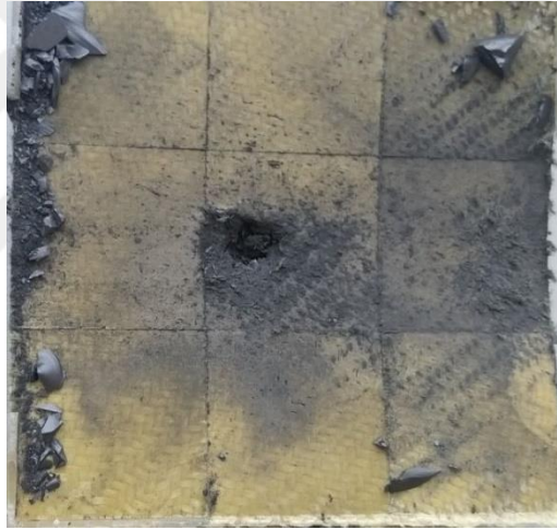
Şekil 7-29 Atışlar Sonucu Numune 3'in Kevlar Yüzeyi
