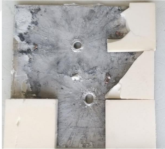
Şekil 7-25 Atışlar Sonucu Numune 2'in Seramik Yüzeyi
