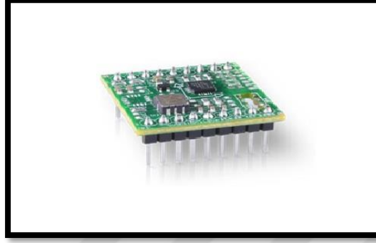
Şekil 3.3 MEMS sensörünün temsili gösterimi (Elprocus, 2018)
