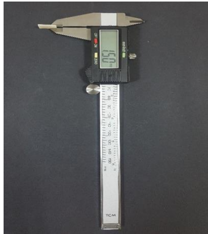
Resim 14: Örneklerin kalınlıklarının ölçülmesi
