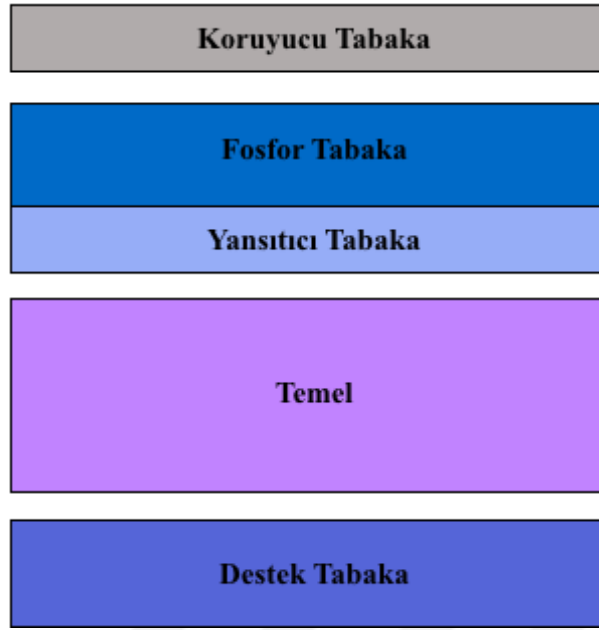
Şekil 1.17. Fosfor depolama plaka iç yapısı [6]
