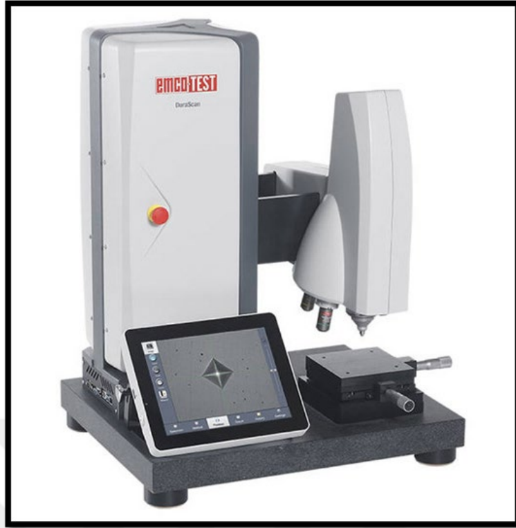
Şekil 3.13. Mikro sertlik test cihazı (yüzeyleri parlatılan numunelerin mikro sertlik ölçümleri)
