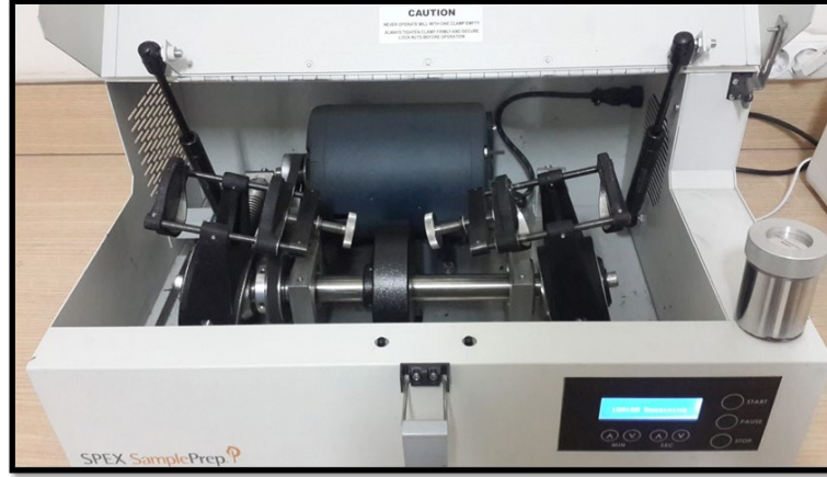
Şekil 3.5. Spex 8000 öğütücü içerisine çelik kapların yerleştirilmesi
