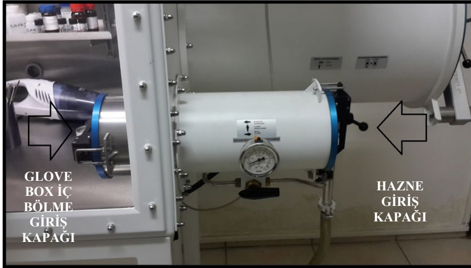
Şekil 3.3. Koruyucu atmosfer ortamı gaz arıtma haznesi ve iç bölme giriş kapakları
