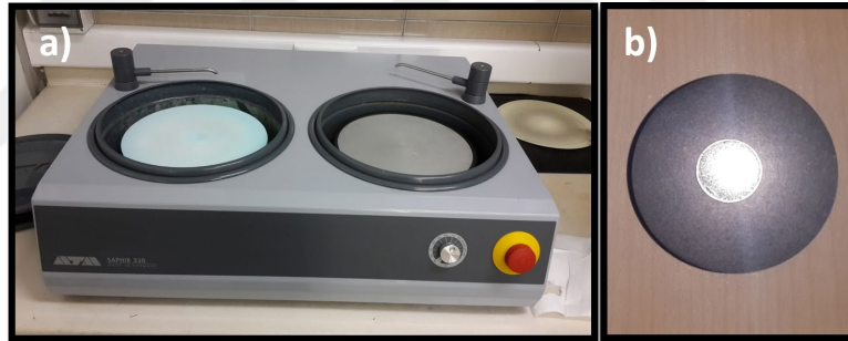
Şekil 3.12. Bakalite alınan metalografik numunelerin yüzey parlatma işlemi a) Parlatma cihazı b) Parlatma işlemi yapılmış numune
