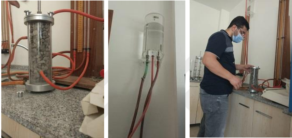
Resim 6.1. Sabit düzeyli geçirimsizlik deneyinin yapılışı
