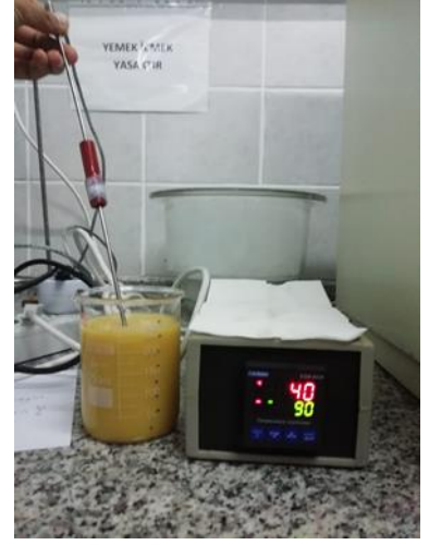
Şekil 3.5. Ultrases destekli alkali nötralizasyon işlemi esnasında kullanılan cihazlar a) Propflu ultrases cihazı b) Ultrases destekli işlem sonrası termokupl ile sıcaklık ölçümü
