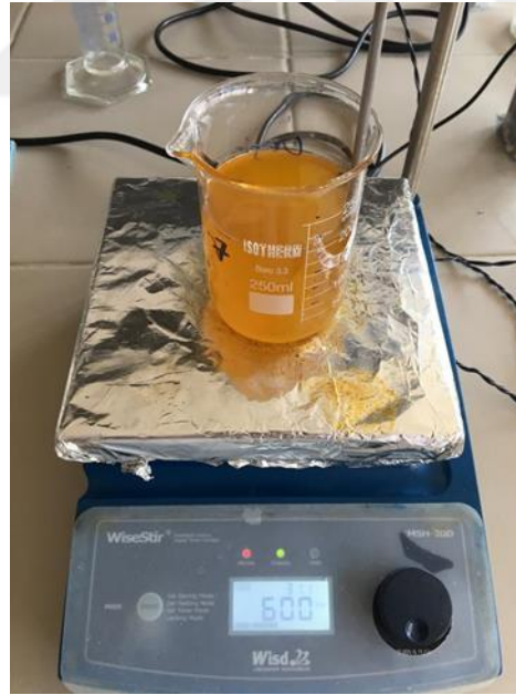
Şekil 3.4. Geleneksel yöntem ile gerçekleştirilen alkali nötralizasyonu işlemi
