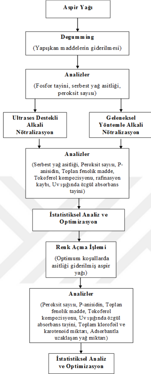
Şekil 3.1 Ham aspir yağında uygulanan rafinasyon basamakları ve işlem akışı
