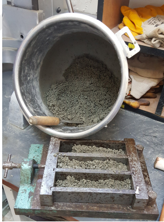
Şekil 3.7: Numunelerin kalıplara yerleştirilmesi.
