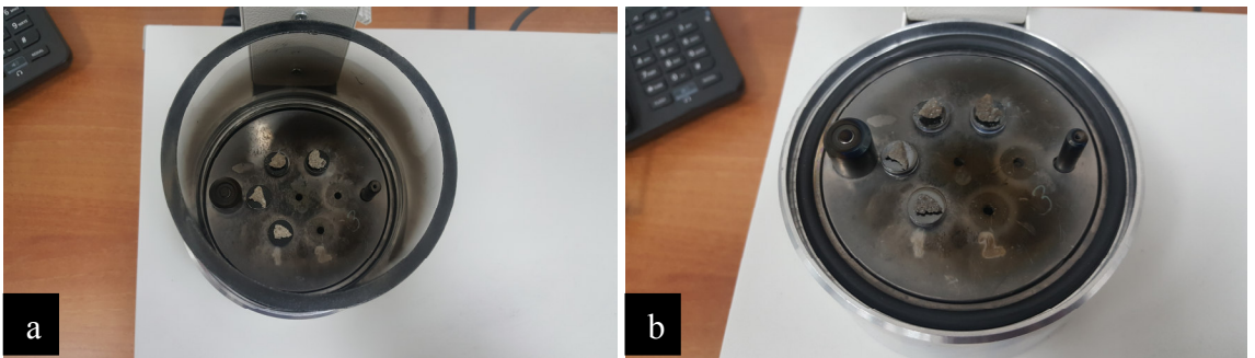
Şekil 3.13: Au-Pd kaplamadan önce (a)/sonra (b).
