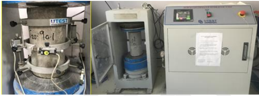
Şekil 3. Numunelerin basınç test düzeneği
