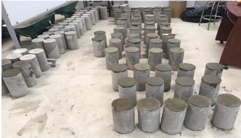
Şekil 2. Başlık yapılmış silindirik numuneler.
