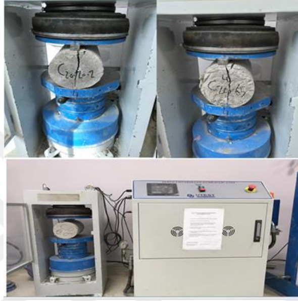
Şekil 4. Silindir yarma düzeneği ile çekme dayanımı testi.
