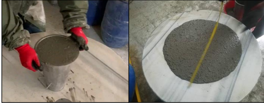
Şekil 3.10 KYB numunelere uygulanan çökme-yayılma testi
