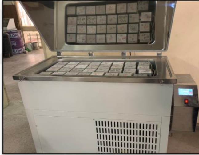
Şekil 3.13 Donma-çözölme test cihazı ve numuneler
