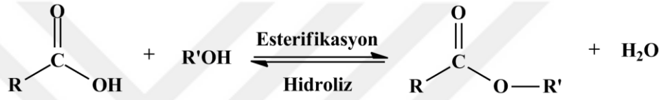
Şekil 2.7 Yağ asitlerinin esterifikasyon reaksiyonu
