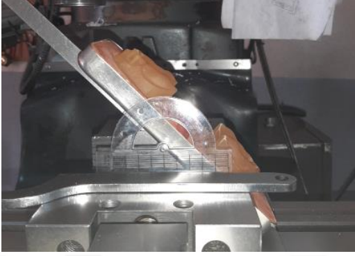
Şekil 3.9. Dijital matkap freze makinesinde, rehber oluklar için tablaya açı verilmesi
