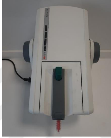
Şekil 3.22. Otomatik ölçü karıştırma cihazı (putty/yoğun kıvamlı ölçü malzemesi için)
