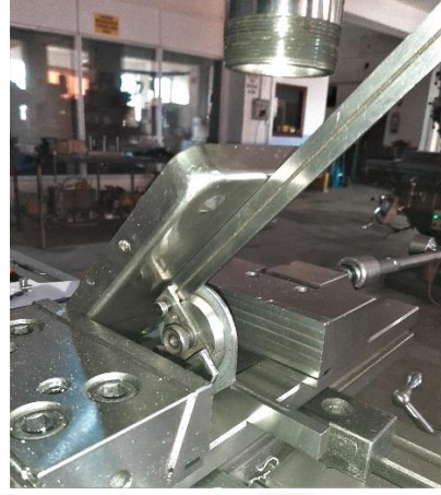
Şekil 3.9. Dijital matkap freze makinesinde, rehber oluklar için tablaya açı verilmesi
