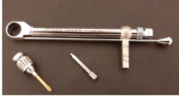
Şekil 3.44. Torklama işlemi için firmaya ait anahtar ve raşet
