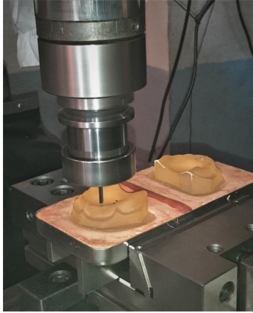
Şekil 3.7. Ana modellerin dijital matkap freze makinesinde sabitlenmesi
