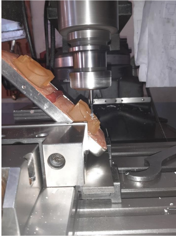
Şekil 3.10. Açılı implantların yerleştirileceği rehber olukların açılması
