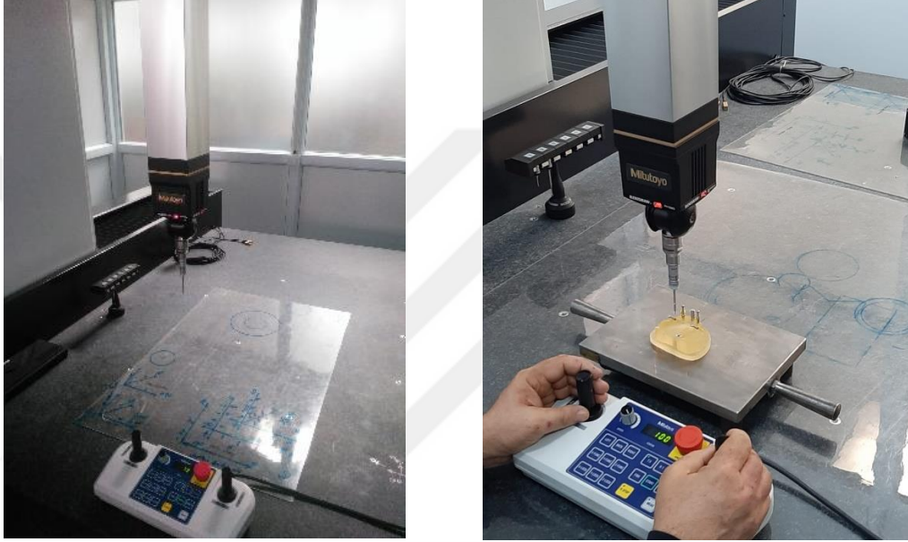
Şekil 3.59. CMM (Koordinat Ölçüm Makinesi) ve kontrol paneli
